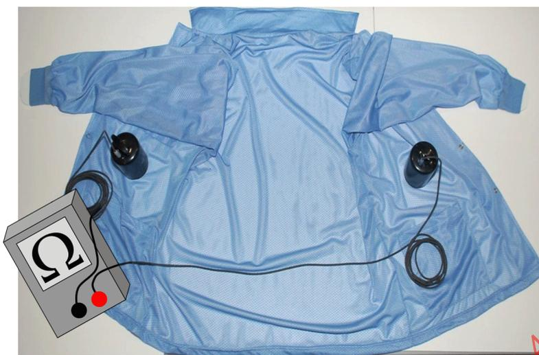
**Figure 3 – Montage d'essai – Résistance point à point
